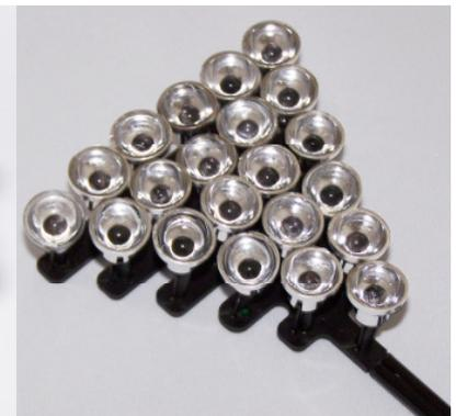
Nun kann das Flutlicht auf der Bahn in ein 6mm Loch gesetzt werden. Um ein durchrutschen des Rohres zu verhindern, zwei Drehungen schwarzes Isolierband unten ansetzen oder mit einem Tropfen Klebstoff das Flutlicht einsetzen. Nun kann durch vorsichtiges Verbiegen jede einzelne LED, wie im mittleren Bild zusehen, ausgerichtet werden.
